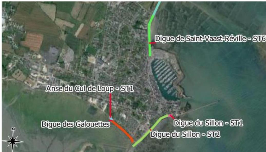
Le scénario S4 a pour objectif d'étudier l'effet d'une propagation des eaux marines dans le cas de défaillances structurelles simultanées du système d'endiguement. Ce scénario se base sur l'aléa de référence PPRL pour lequel toutes les défaillances structurelles de l'ensemble des ouvrages sont considérées.
